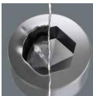
Проблема винтов с внутренним шестигранником состоит в том, что опорные поверхности, передающие усилие с отвертки на винт, очень узкие. Поэтому головка винта может разрушаться. Отвертка с профилем Hex-Plus имеет довольно большую опорную поверхность, которая препятствует этому! Полезно знать: инструменты Hex-Plus подойдут к любому стандартному винту с внутренним шестигранником.
