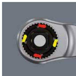
Благодаря двойному храповому механизму 38 прочных зубцов действуют как тонкий механизм из 76 мелких зубцов с углом возврата всего 4,7°.
