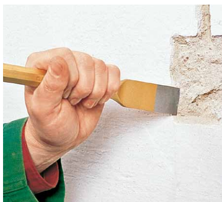
Пазовое зубило, восьмигранный профиль Slotting chisels, octagonal
