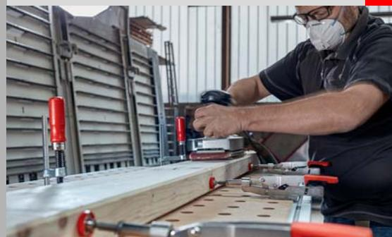
■ Для применения быстрозажимных устройств BESSEY на многофункциональных столах, например Festool MFT и Sortimo WorkMo, с диаметром отверстия 20 мм и толщиной столешницы от мин. 19 мм до макс. 25 мм
