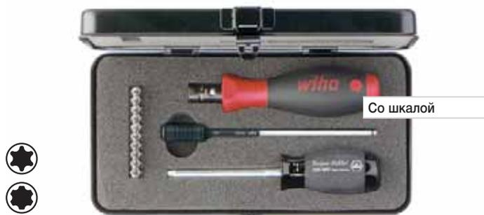
**2852 S10-01** Набор динамометрических отверток TorqueVario-S, 13 предметов. Настройка значения крутящего момента с помощью шкалы. С универсальным держателем битов и 10 битами TORX®/ TORX PLUS® Standard, специально для неперетачиваемых режущих пластин.
