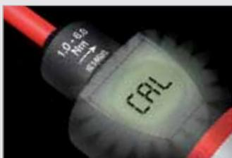
Сигнал калибровки после 5000 использований для абсолютной надежности процесса контроля средств измерения. При заказе возможно индивидуальное задание циклов сигнала калибровки.
